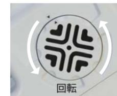
ヘッドの冷却は、メンテナンスがしやすい空冷方式です。防塵フィルターの取り換えは、ワンタッチで簡単におこなえます。
